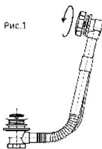
Все ванны (кроме Capri 160x100 и Palau 140x140) торговой марки **Aquanet** комплектуются устройством слива-перелива (полуавтомат). Закрытие донного клапана происходит путем поворота механизма на переливе.
