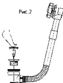
Ванны Capri 160x100 и Palau 140x140 комплектуются устройством слива-перелива (автомат). Закрытие донного клапана происходит путем нажатия на сам клапан.
