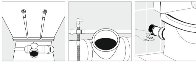
2. Соедините унитаз с выходом канализации с помощью отвода, определив место его расположения. Отметьте через монтажные отверстия постамента унитаза места сверления на поверхности пола под монтажные дюбели.
