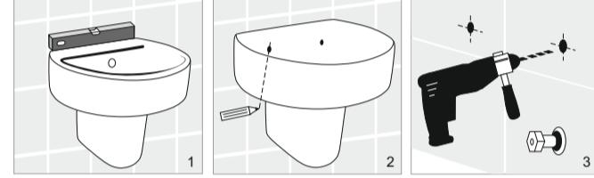
1. К приготовленной для монтажа стене приложите умывальник, установив его на пьедестал и выровняв его по горизонтали, используя уровень (рис 1).
